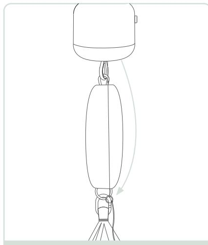
**5** Montarea motorului cu fir
