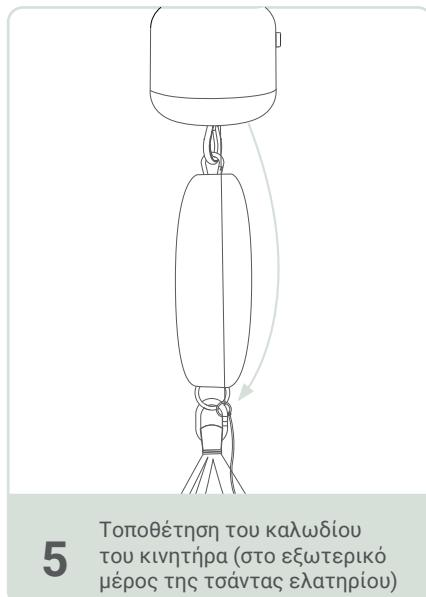
**5** Τοποθέτηση του καλωδίου του κινητήρα (στο εξωτερικό μέρος της τσάντας ελατηρίου)
