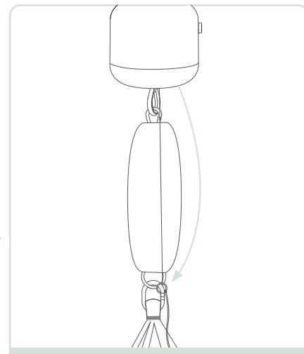
**5** Montáž kabelu (na vnější straně ochraného pytlíku na pružinu)
